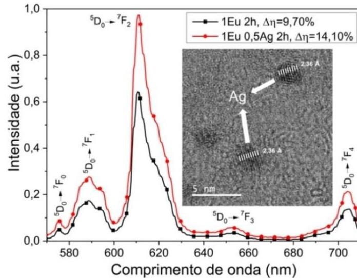
**Figura 4** - Espectros de emissão (excitação em 405 nm) das amostras de vidro GPA; o *inset* apresenta uma imagem de MET da amostra GPA com 1,0% de  $\text{Eu}_2\text{O}_3$  e 0,5% de  $\text{AgNO}_3$ , onde é possível visualizar as NPs de Ag e sua distância interplanar característica.
