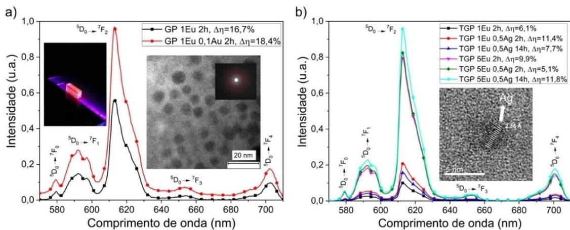
**Figura 3** – a) Espectros de emissão (excitação em 405 nm) das amostras de vidro GP; o *inset* mostra uma imagem da amostra emitindo luz e uma imagem de MET das NPs de Au, presentes na amostra
