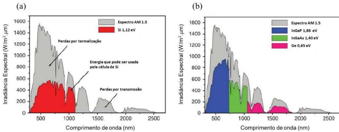
**Figura 1** - Espectro solar AM1.5 e exemplos de resposta espectral da (a) célula solar de Si e da (b) célula solar de multijunção [4].
