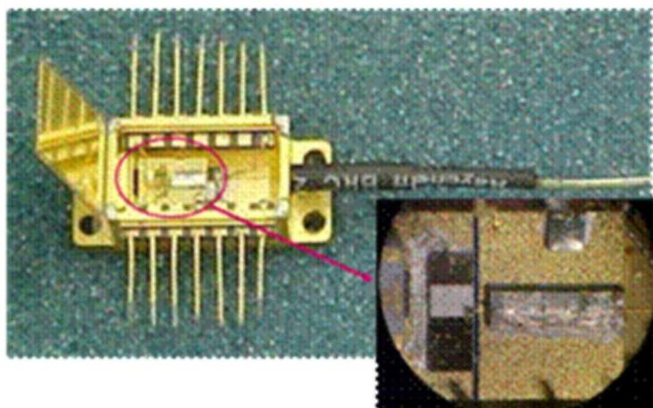
**Figura 4** – Laser semiconductor encapsulado [7]. O encapsulamento é metálico hermético, garantindo total isolamento ambiental do laser, inclusive temperatura.
