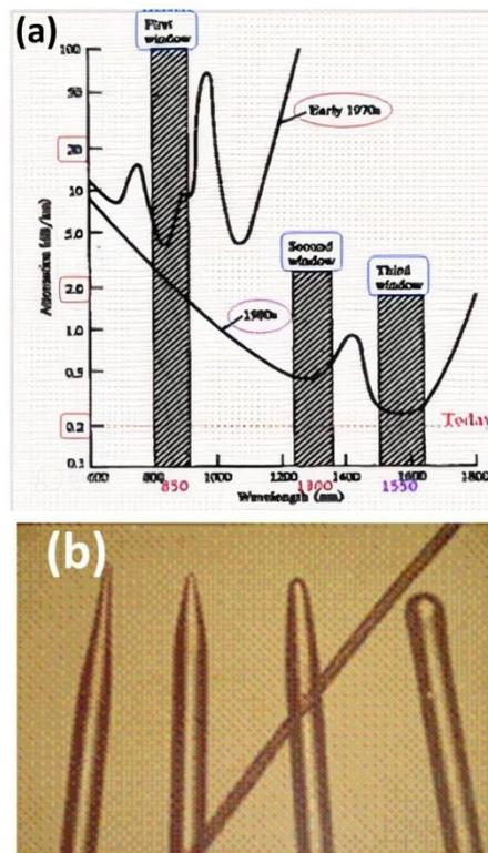
**Figura 3** – (a) Atenuação de fibras óticas de sílica [3]. A primeira janela é em torno de 850 nm; a segunda em torno de 1300 nm; e a terceira no entorno de 1550 nm, sendo que hoje estende-se aproximadamente de 1460 a 1620 nm;
