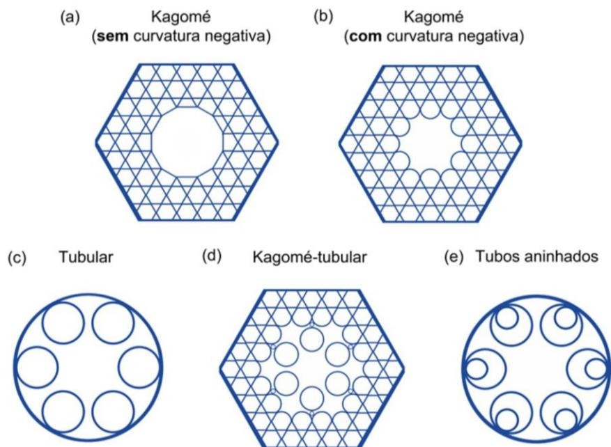
**Figura 1** – *Designs* de HCPCFs. (a) Fibras Kagomé sem curvatura negativa, (b) fibra Kagomé com curvatura negativa, (c) fibra tubular, (d) fibra híbrida Kagomé-tubular e (e) fibra com tubos aninhados.
