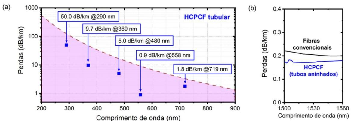
**Figura 2** – (a) Novos valores recordes para atenuação de fibras ópticas com guiamento no espectro visível e ultravioleta obtidos a partir da utilização de fibras tubulares [4]. Linha tracejada: limite de espalhamento Rayleigh da sílica. (b) Resultados de atenuação recordes para HCPCFs com tubos aninhados e perdas de fibras tradicionais no infravermelho (gráfico adaptado de [6]).
