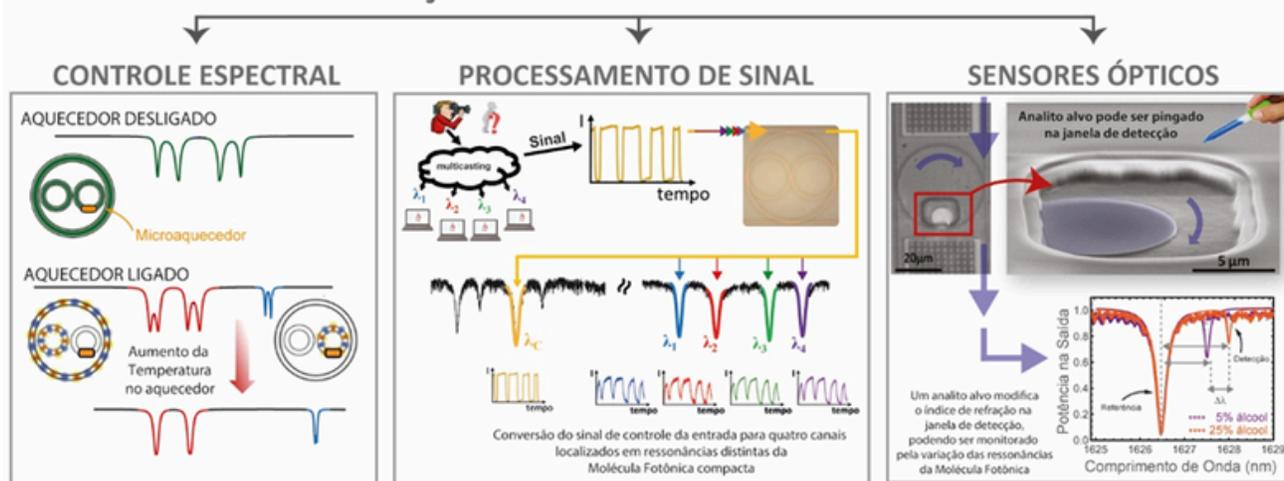
que o controle em apenas um dos anéis internos é suficiente para sintonizar o acoplamento entre esses anéis, cessando o acoplamento contra-propagativo presente, garantindo a transição de um quadrupeto, por exemplo, para um duplete de ressonâncias.
