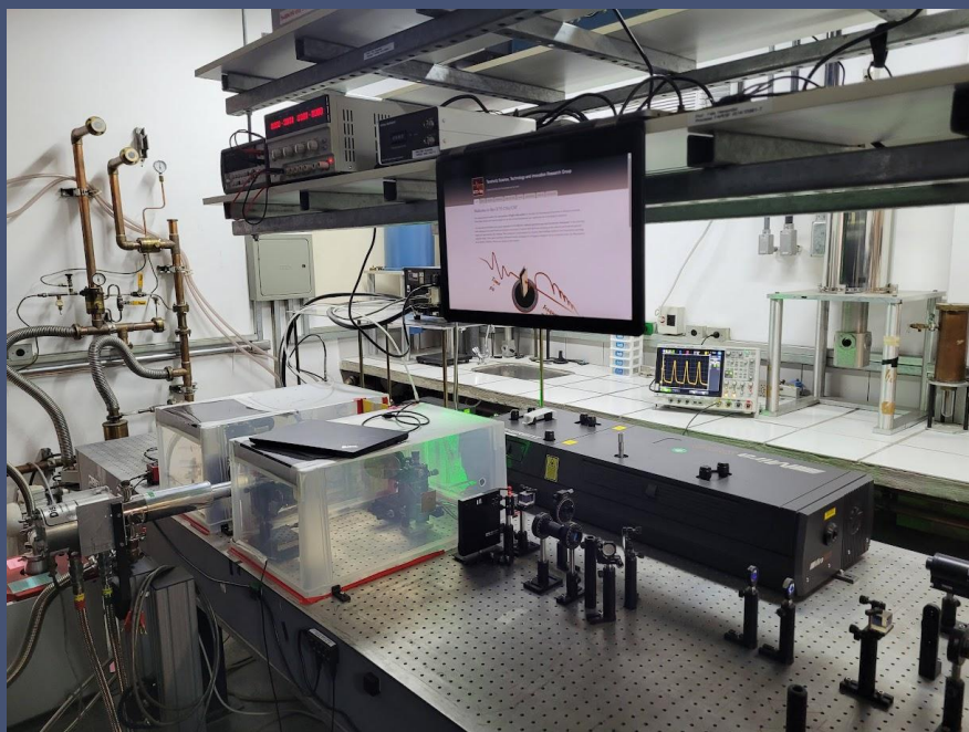
FIGURA 3 – Fotografia da infraestrutura experimental implementada pelo GCTI-THz/USP para medidas de THz-TDS, em geometria de transmissão. O sistema está preparado para experimentos em baixas temperaturas (acima de 10 K) e para medidas de polarimetria terahertz, operando em uma janela espectral de 0,1 a 2 THz, com uma resolução espacial milimétrica, próxima ao limite de difração nessa faixa espectral.
