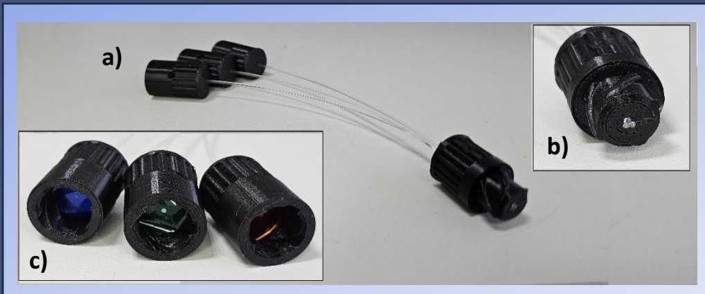
FIGURA 3: a) módulo demultiplexador completo, composto por três fibras, com b) detalhe do conector de entrada e c) detalhe dos conectores de saída com seus respectivos filtros de cor feitos a de filmes BOPP.
